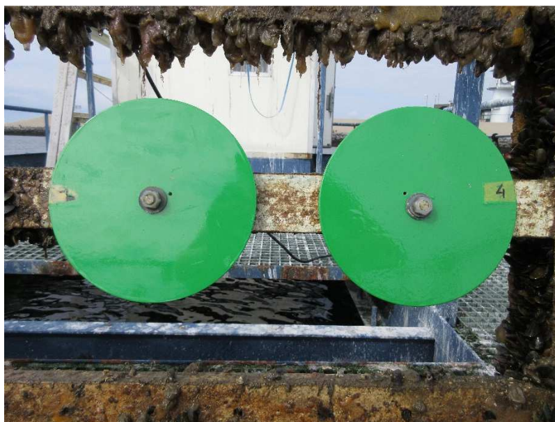
Figuur 1. Overzicht van de twee aangeleverde schijven, hier geplaatst op het testvlot van Endures in de haven van Den Helder nadat de EIS-metingen verricht zijn.
